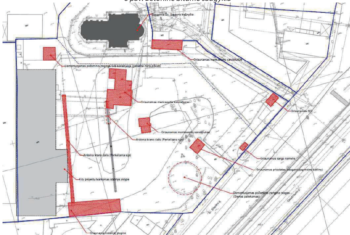
7 pav. Teritorijos rekonstrukcijos projektas, griaunami pastatai
